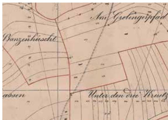
*Points du canevas représentés par des triangles sur le plan A1 de Hoscheid de 1829*
